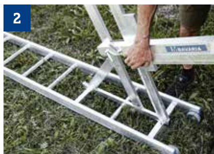
2 Position der Pfosten passend zum Dachüberstand einstellen.
